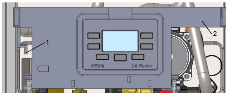
Рисунок 9 - демонтаж облицовки и передней панели
